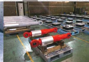
オイルダンパーにより地震力を吸収し揺れを抑えます。
